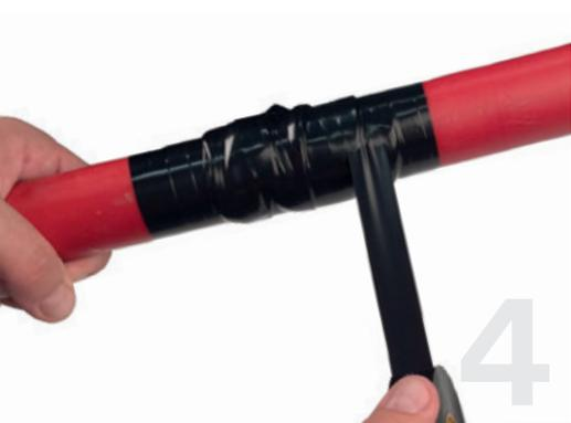
Unser Reparaturband ist Schwarz, aus Buthyl-Kautschuk, verschweißt zu einer elastisch plastischen Schicht mit sehr guter Alterungsbeständigkeit und Korrosionsfestigkeit, lässt sich dehnen und formen und bei Minustemperaturen verarbeiten. Das Band ist beständig gegen viele Lösungsmittel und Fette. 3M™ Scotchfil™ Selbstverschweißendes Buthyl-Kautschuk-Band wird zur Abdichtung und Polsterung eingesetzt und ist Bestandteil der Kabelmantel-Reparatursysteme.
